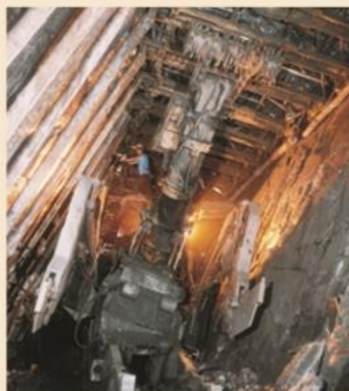
▲ En 1982, 24 machines d'abattage ANF équipent les chantiers en dressants.
